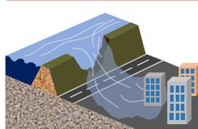
中上流部の堤防が決壊しなかったため、下流淀川への到達流量が増加。これにより、淀川では計画高水位を超過し、**淀川左岸で堤防が決壊**。洪水時には、寝屋川流域では流域内の唯一の出口である京橋口から大川を経て毛馬排水機場から淀川に排水しているが、淀川本川が計画高水位を超過した場合、**毛馬排水機場からの排水を停止せざるを得ず、寝屋川流域では大規模な浸水被害が発生。**
